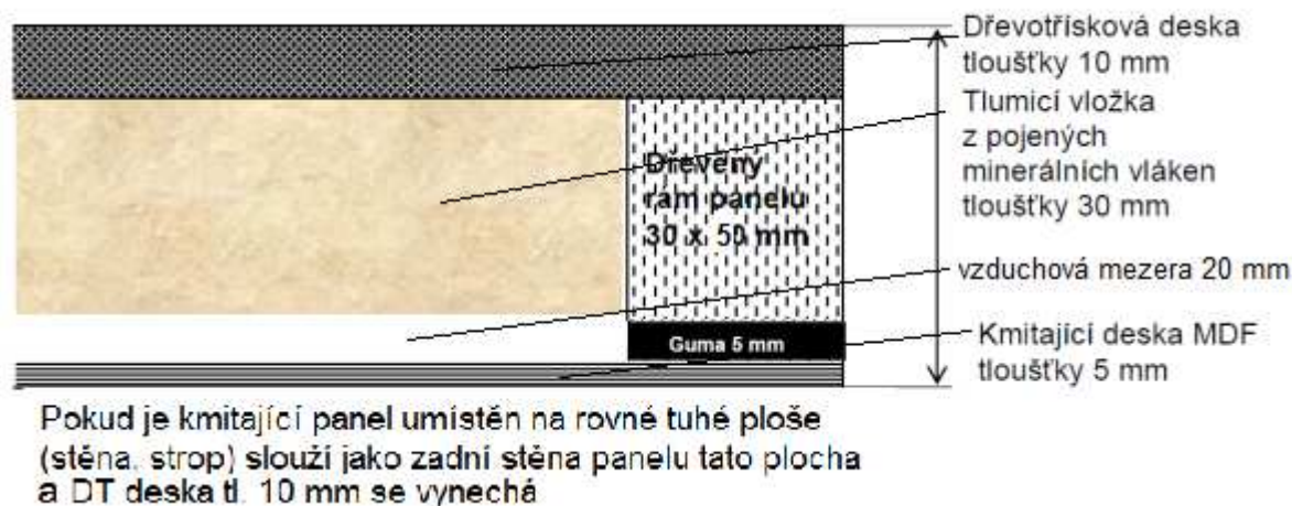
Obrázek 3: Řez kmitajícím panelem (KP)
